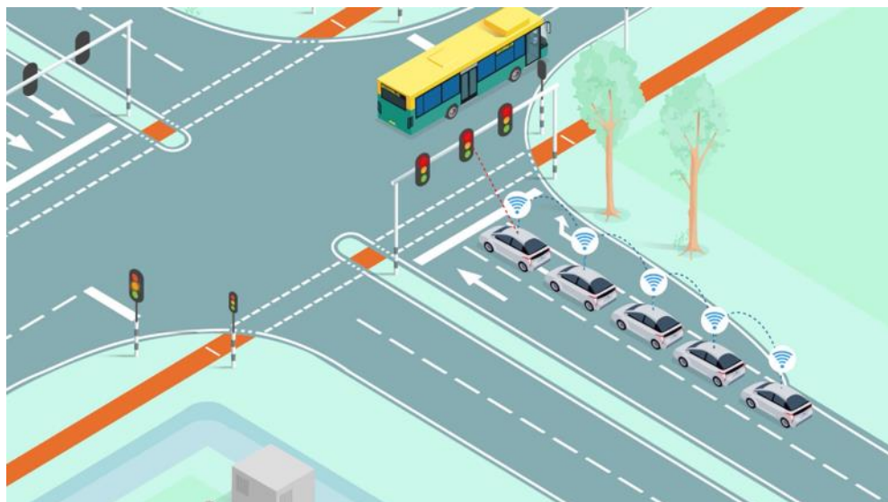
Figuur 2.1, Communicatie tussen testvoertuigen en intelligente verkeerslichten
