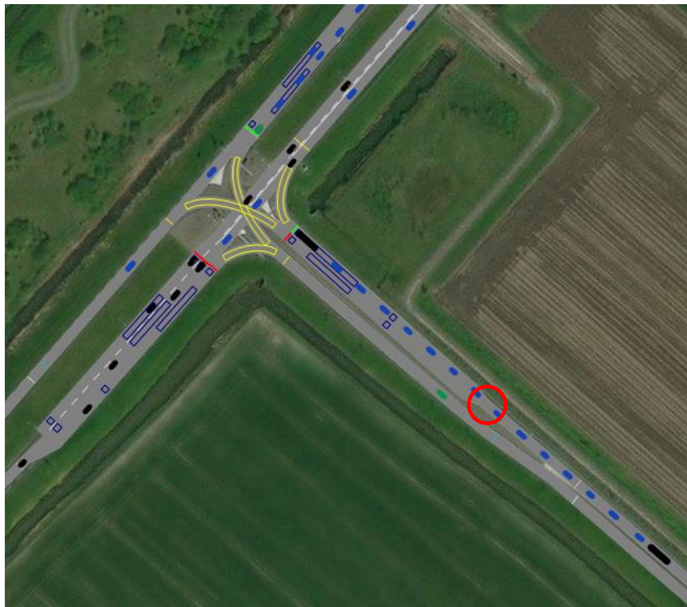
Figuur 3.3 Voorbeeld van 100% ACC op zuidelijke kruising van Driemeren weg met Noordelijke Randweg. Op deze kruising wordt de linker voorsorteerstrook geblokkeerd. De rode cirkel geeft de locatie van de geblokkeerde linkerstrook weer.
