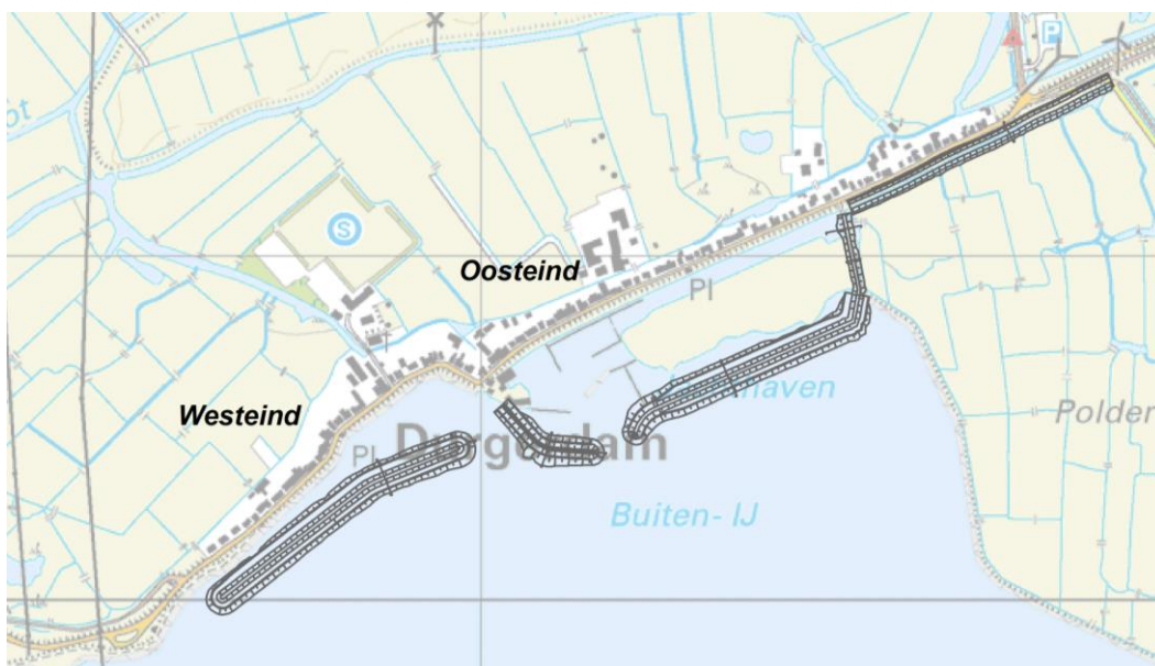
Figuur 17. Overzicht Combinatievariant 1, van west naar oost, golfbreker, golfbreker, buitenwaartse berm, dakje, vierkant
