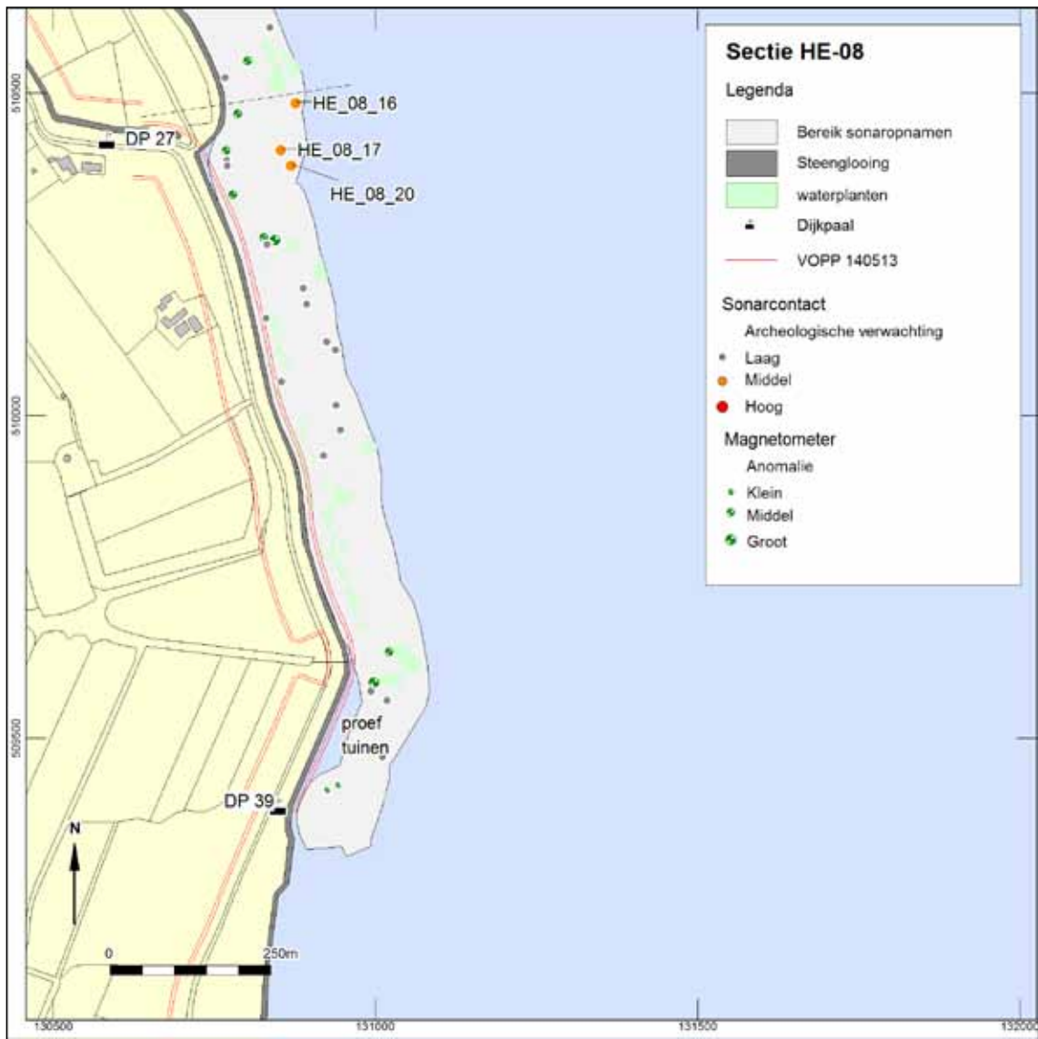
Afb. 10.21 Overzicht van de resultaten langs dijksectie HE-08, Keukendijk.
