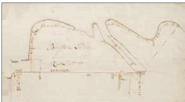
Afb. 8.21-8.22 Twee situatietekeningen van Schardam (collectie WA). Boven: ontwerp voor een nieuw uitwateringskanaal uit 1651.
