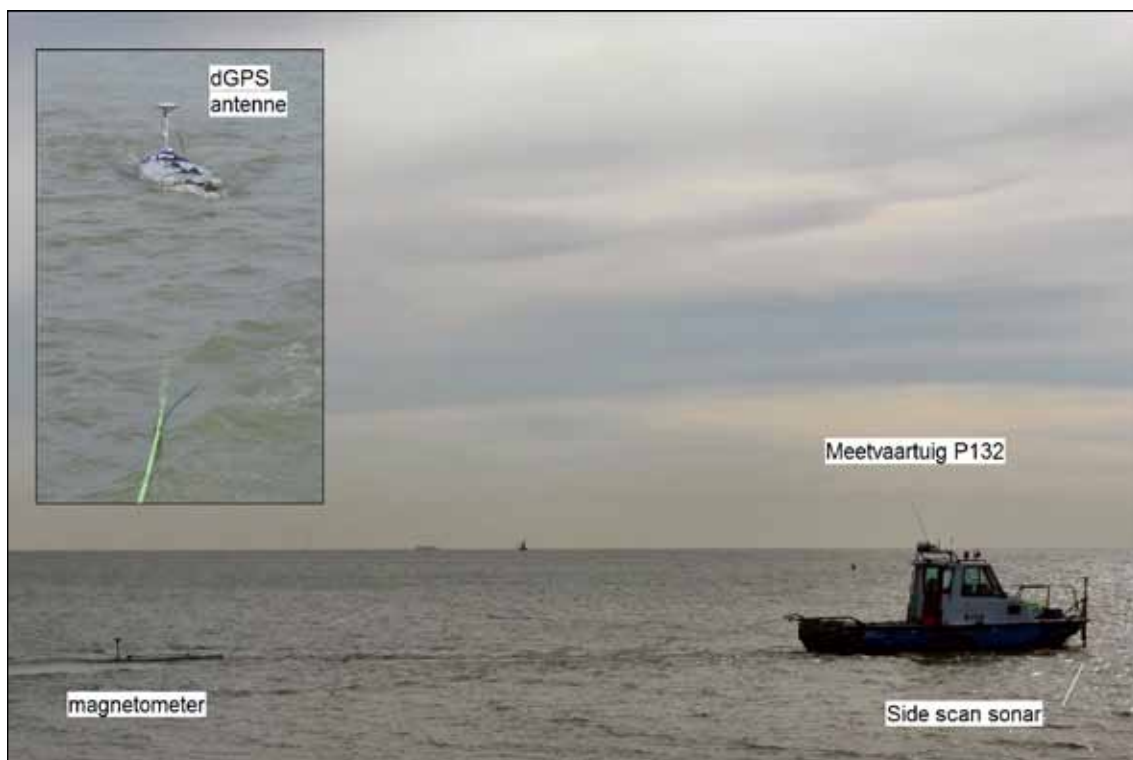
Afb. 10.1 Het meetvaartuig P132 met sonar en magnetometer.
