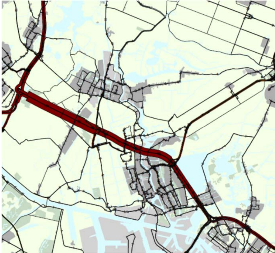
Figuur 4.14: Selected Link nieuwe wegverbinding A8 - A9 ten westen van de N246
