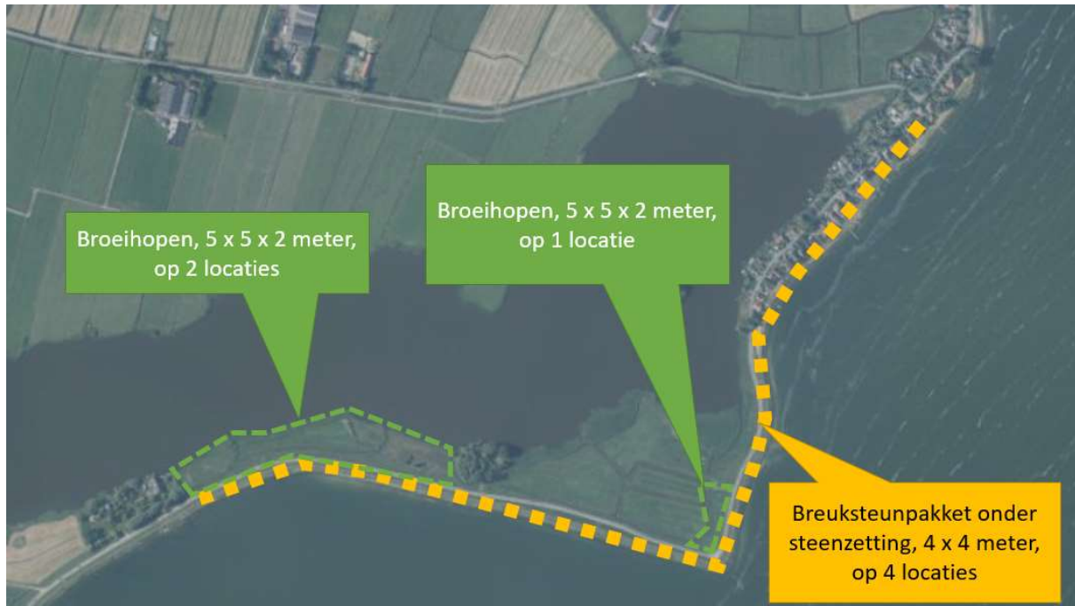
Afbeelding 39: Compensatiemaatregelen op de locatie "Uitdam" (zie voor locatie Afbeelding 29). Aan de buitenzijde moeten op vier locaties breuksteunpakketten onder de steenzetting worden gerealiseerd. Aan de binnenzijde moeten broeihopen worden gerealiseerd op drie locaties binnen de groene onderbroken lijn. De exacte locatie is nog niet bekend. Het is belangrijk dat de broeihopen niet te dicht bij de dijk komen te liggen, omdat hier werkzaamheden plaatsvinden. Grenzend aan de dijk ligt beschermd natuurgebied (NNN). Ter plekke wordt bepaald waar de broeihoop het minst schade oplevert en daar zal deze geplaatst worden.
