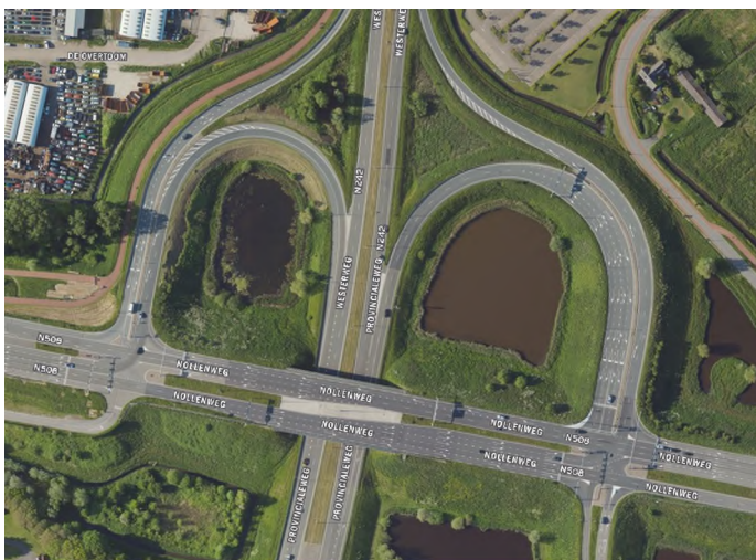
Figuur 3.3: Aansluiting N508: Principe Halfklaverblad, N508 kruist bovenlangs.
