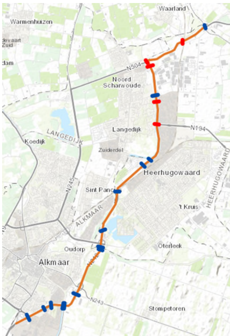
Figuur 9.7: Barrière werking N242 voor fietsers en voetgangers. Op de kaart staan de gelijkvloerse (rood) en ongelijkvloerse (blauw) kruisingen aangegeven.
