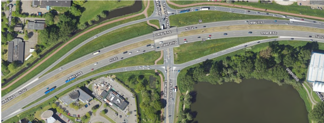
Figuur 3.2: Aansluiting Diamantweg: Principe Haarlemmermeer, Diamantweg kruist onderlangs.
