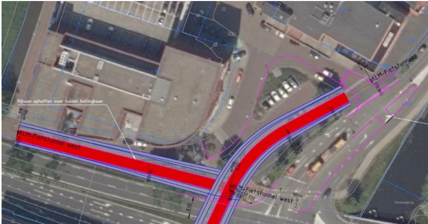
Figuur 7: Variant 3 noordzijde met westelijke hellingbaan welke is komen te vervallen
