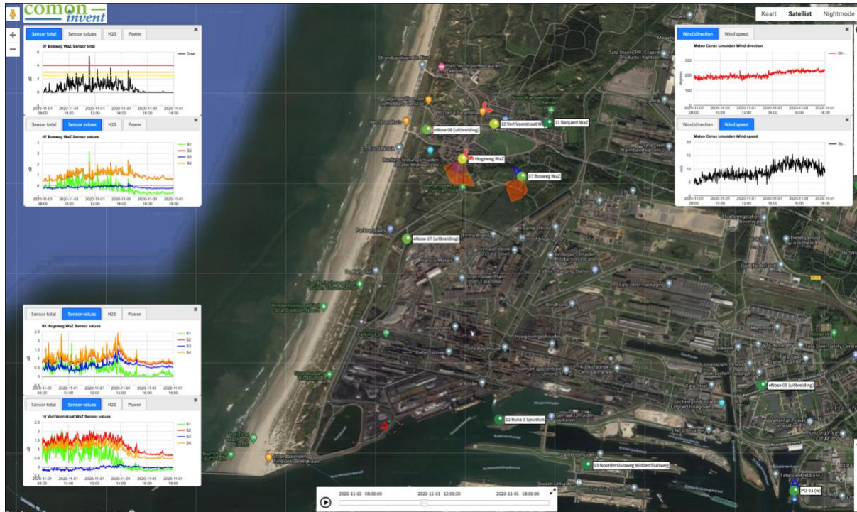
Figuur 14: eNose 07 Bosweg WaZ registratie op 1 november 2020 om 12:00 uur voor een tijdvak van 08:00 tot 18:00 uur. De wind/pollutierozenwijzen richting de bron, KGF2 batterijen.
