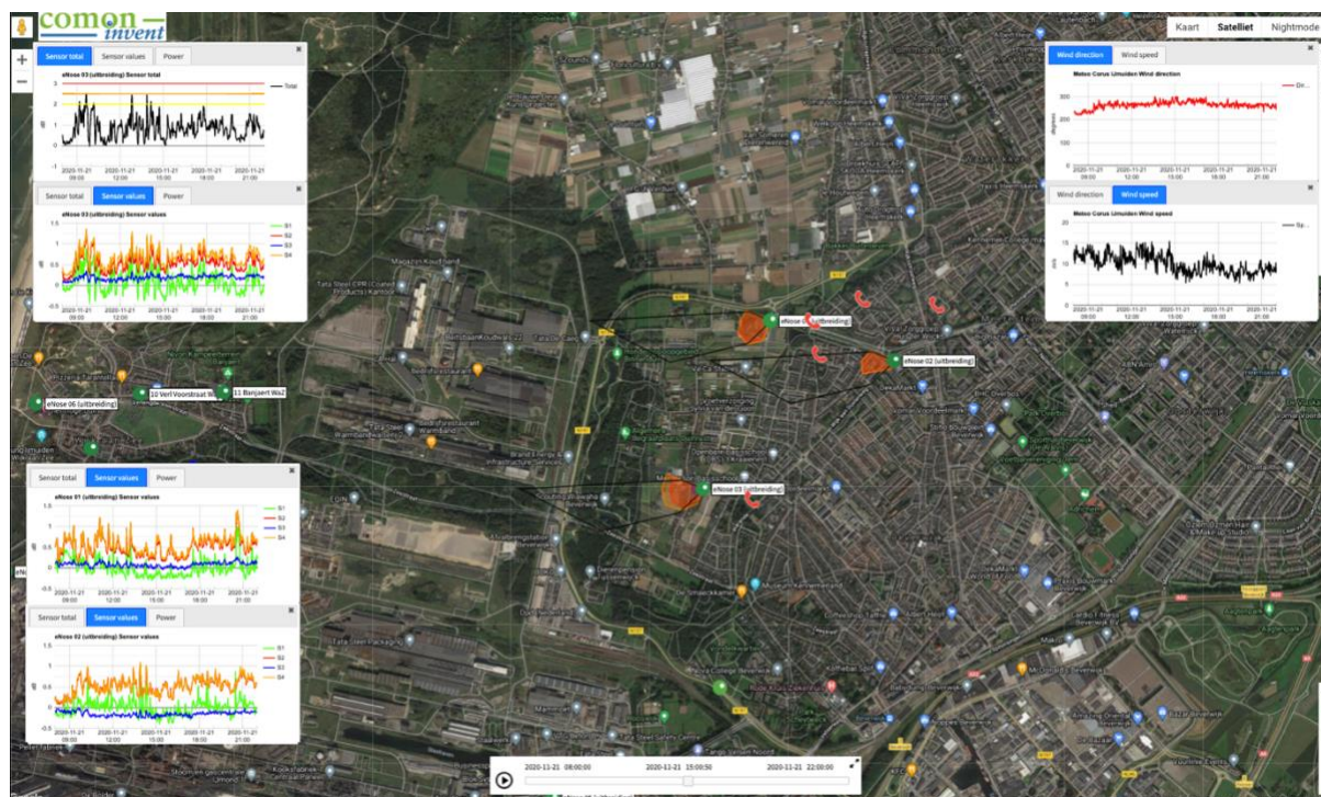
Figuur 8: eNose 03 (uitbreiding) registratie op 21 november 2020 om 10:00 voor een tijdvak van 08:00 tot 22:00 uur. De wind/pollutierozen wijzen naar de mogelijke bron ten westen van de eNoses. De bron is hier KBW2 Beitsbaan.
