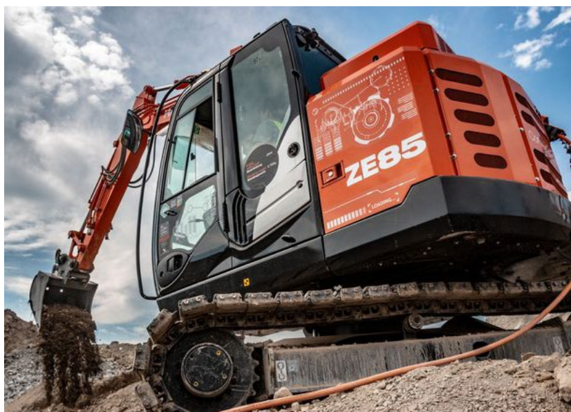
Afbeelding 7 | De 8,5 ton graafmachine ZE85 van Hitachi, aangedreven door accu's 30)
