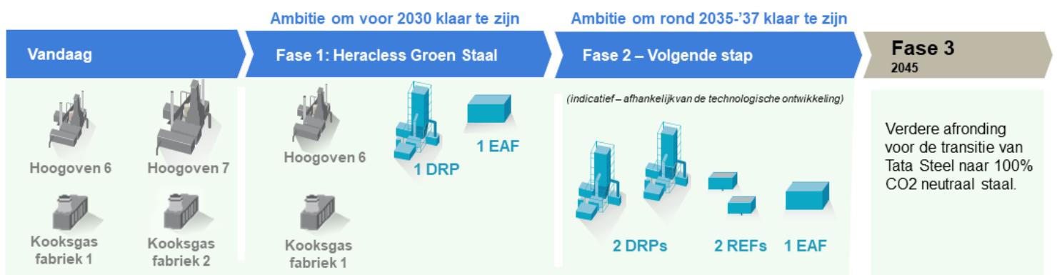
Figuur 1. Schematisch overzicht stappenplan van Tata Steel om te komen tot groene staalproductie, met daarin als eerste stap voor 2030 de realisatie van het Heracless-Groen Staal project.
