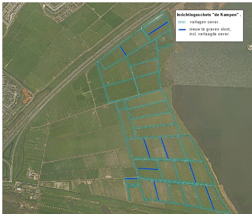
Figuur 2: Verlagen bestaande slootoevers, graven nieuwe sloten incl. verlaagde oevers.
