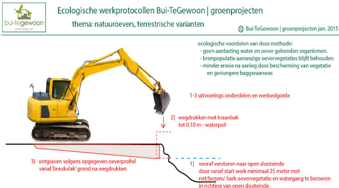
Afbeelding 5.9 Werkwijze aanpassen oevers
