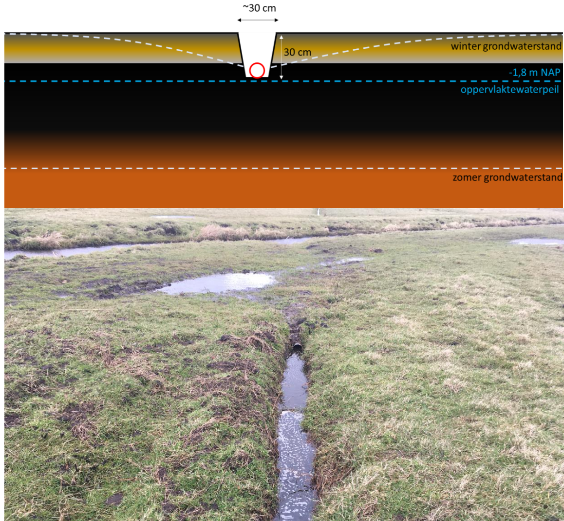
Afbeelding 4.5 Dwarsdoorsnede van een greppel. De rode cirkel geeft de ligging van de kopakkerbuis aan. Onder de schematische weergave een foto van een greppel met kopakkerbuis
