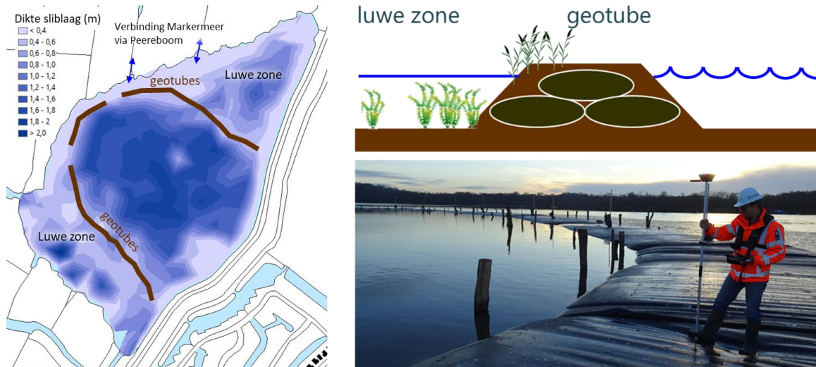
Afbeelding 5.16 Geotube oplossing in de Oosterpoel
