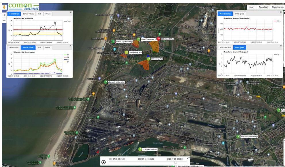
Figuur 11: eNose 11 Banjaert WaZ registratie op 18 juli 2020 om 08:51 uur voor een tijdvak van 08:00 tot 09:00 uur. De wind/pollutierozenwijzen richting de bron. Door analyse data van de eNoses data op het Tata Steel terrein kon de mogelijke bron achterhaalt worden, dit was KGF2.)
