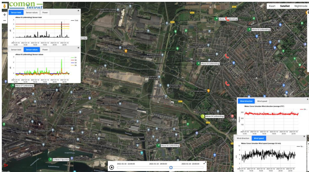
Figuur 8: eNose 03 (uitbreiding) registratie op 10 januari 2021 om 18:50 voor een tijdvak van 12:00 tot 23:00 uur. De wind/pollutieroos wijst naar de bron ten westen van de eNose. De bron is hier KBW2 Beitsbaan.
