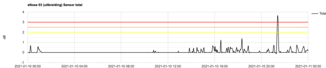
Figuur 6: Totale sensorwaarden van eNose 03 (uitbreiding) op 10 januari 2021.
