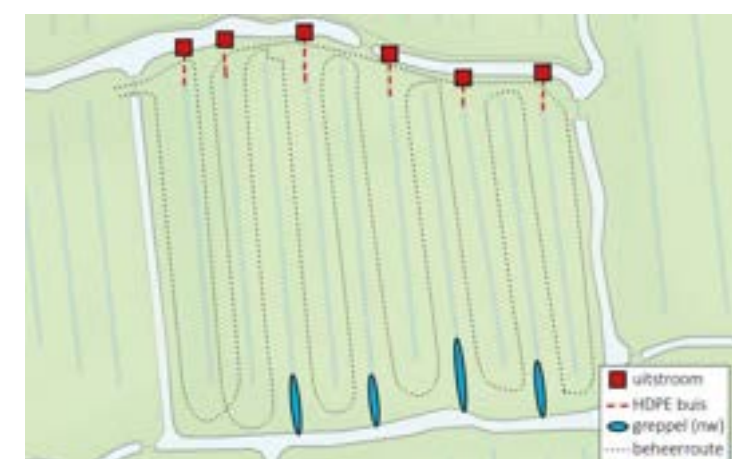
Figuur 6-3: Principetekening variant C, greppels solistisch verbinden met een kopakkerbuis
