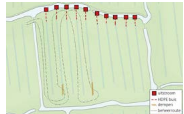
Figuur 6-2: Principetekening variant B, greppels solistisch verbinden met een kopakkerbuis
