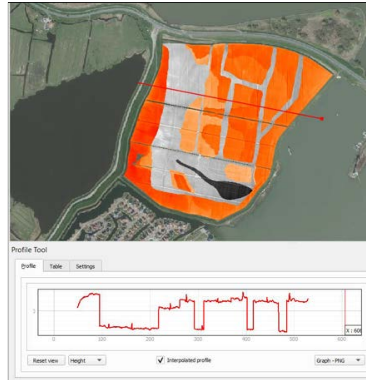
Figuur 6-7: Berekende ontgraving / ophoging op basis van gewenste globale hoogteligging na inrichting
