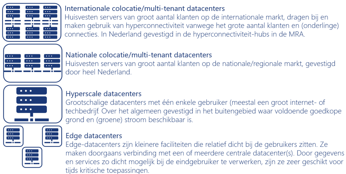
Figuur 4: Overzicht verschillende typen datacenters
