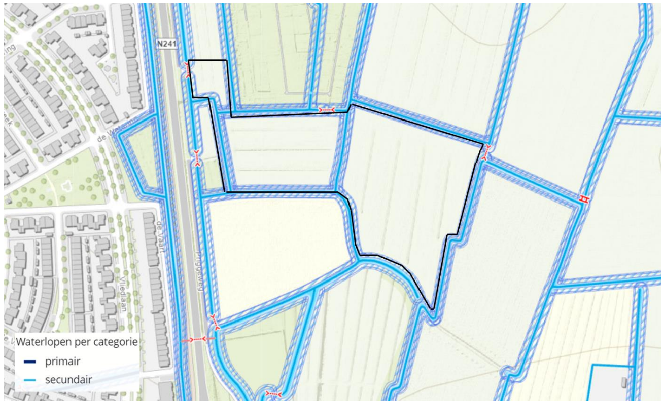
Figuur 2-1 Uitsnede legger oppervlakte waterlichamen, duikers zijn aangegeven in het rood (bron: legger wateren, Hoogheemraadschap Hollandse Noorderkwartier)
