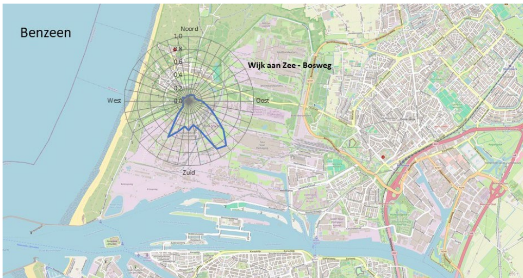
Figuur 35 Jaargemiddelde Benzeen concentratie ( \mu\text{g}/\text{m}^3 ) per windrichting in 2023 op het meetstation (blauw).
