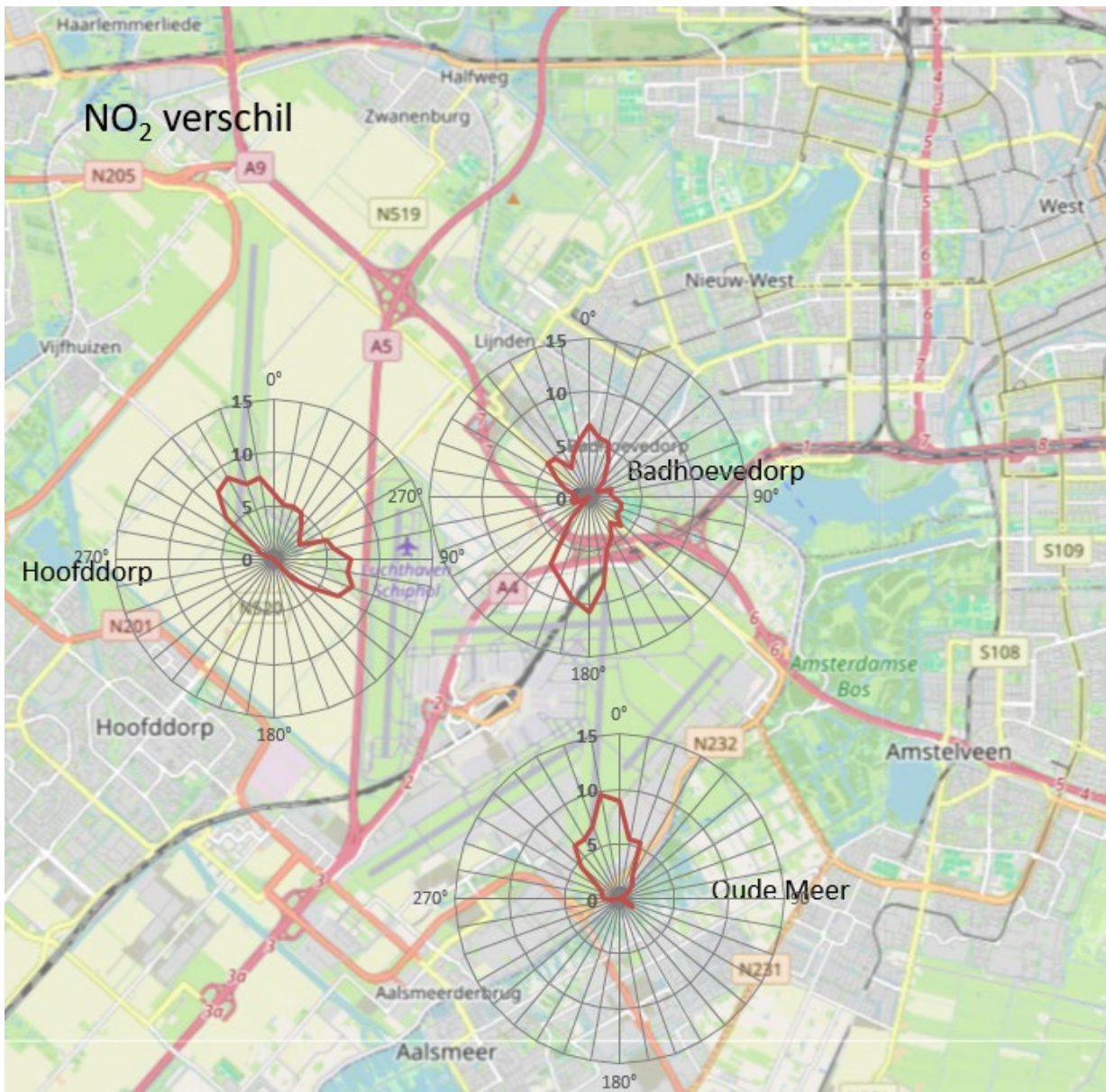
Figuur 10. Verschil tussen gemiddelde NO 2 concentratie (µg/m 3 ) op het betreffende meetstation en op de achtergrondstations per windrichting.
