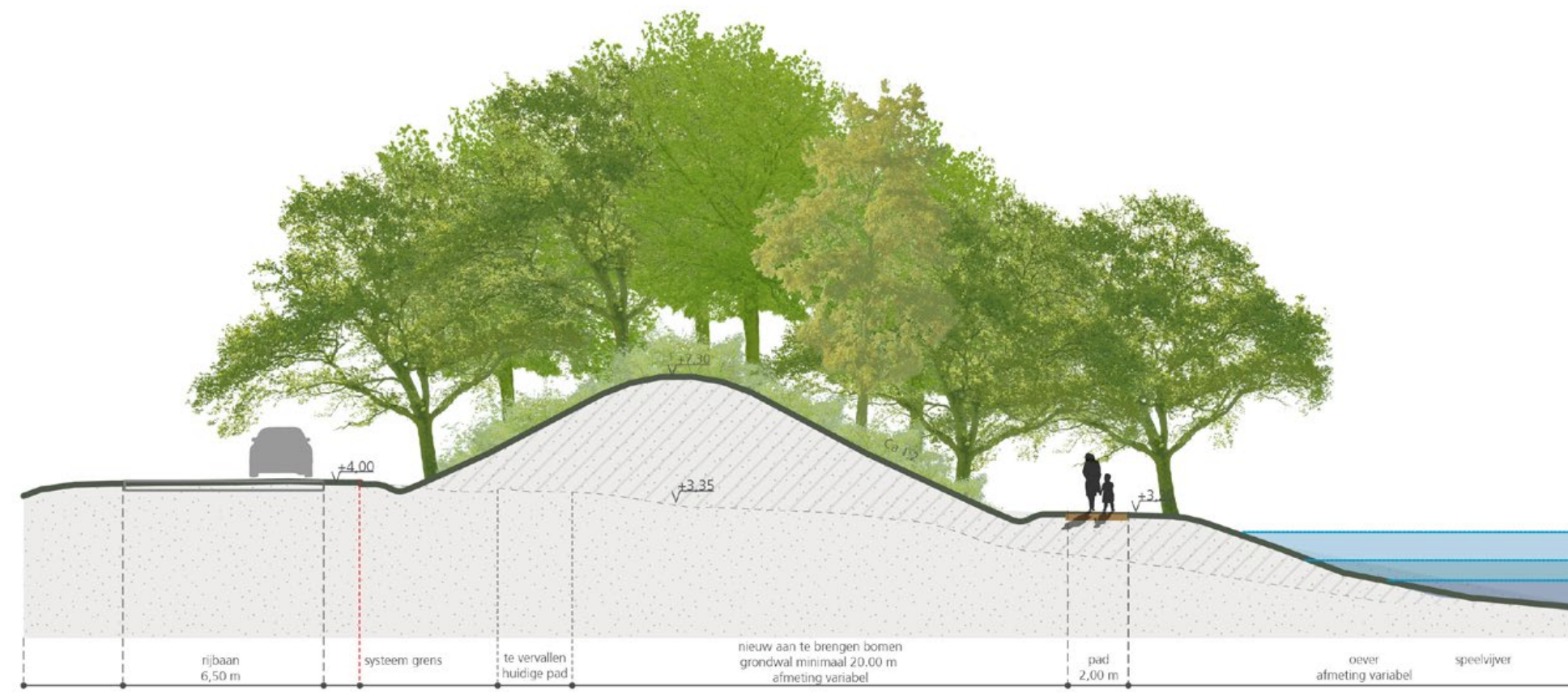
Profiel 2 - Grondwal tpx. speelvijver Grondwal (5) schaal 1:200
