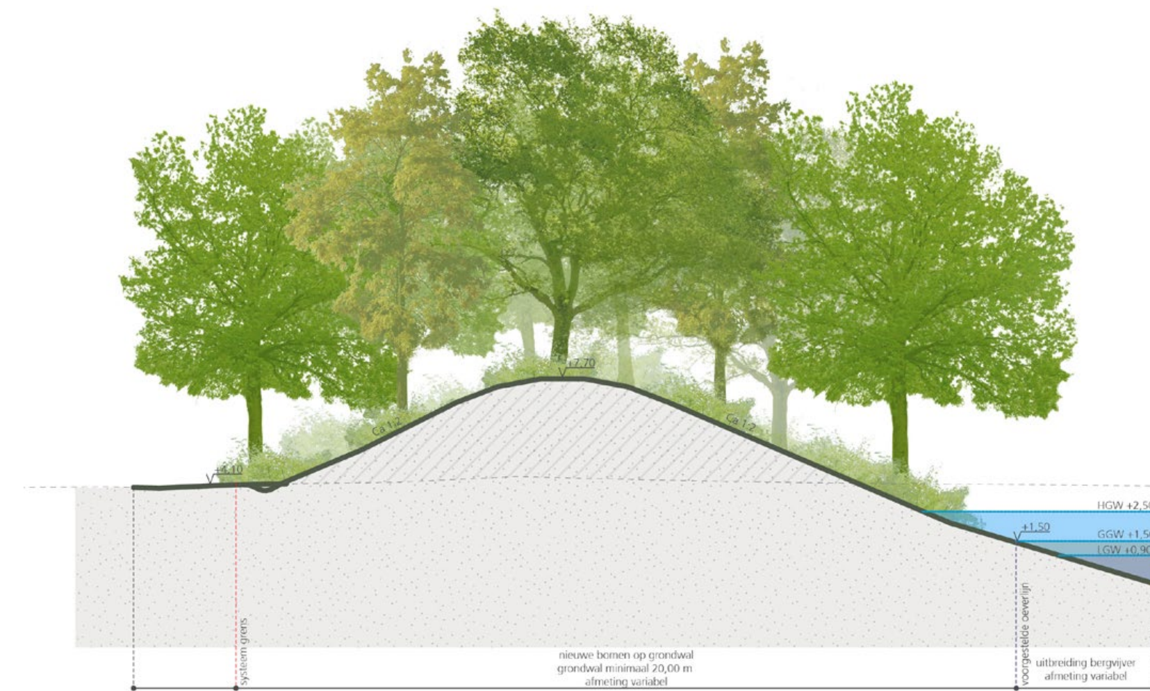
Profiel 6 - Grondwal tpx. uitbreiding bergvijver Grondwal (6) schaal 1:200
