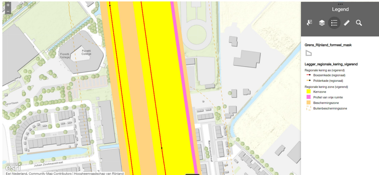
Figuur 5 - Ligging van de keringen en bijbehorende beschermingszone's langs de Ringvaart. Screenshot uit de legger van het Hoogheemraadschap van Rijnland
