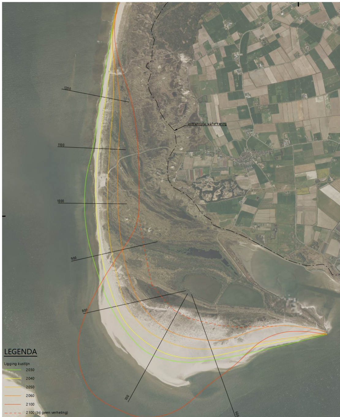
Afbeelding 4.1 Schetsontwerp Variant 2: Wildernisgebied zonder beheer. Let op: de morfologische verwachting kent een hoge mate van onzekerheid
