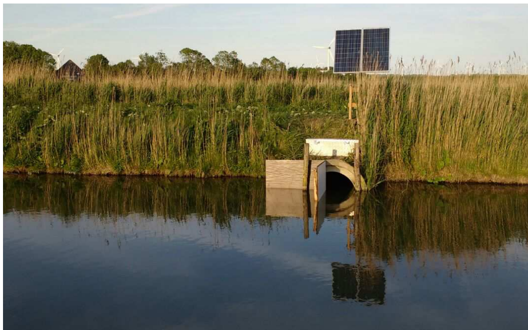
Figuur 4: opstelling onderwatercamera voor de duiker in NVO2
