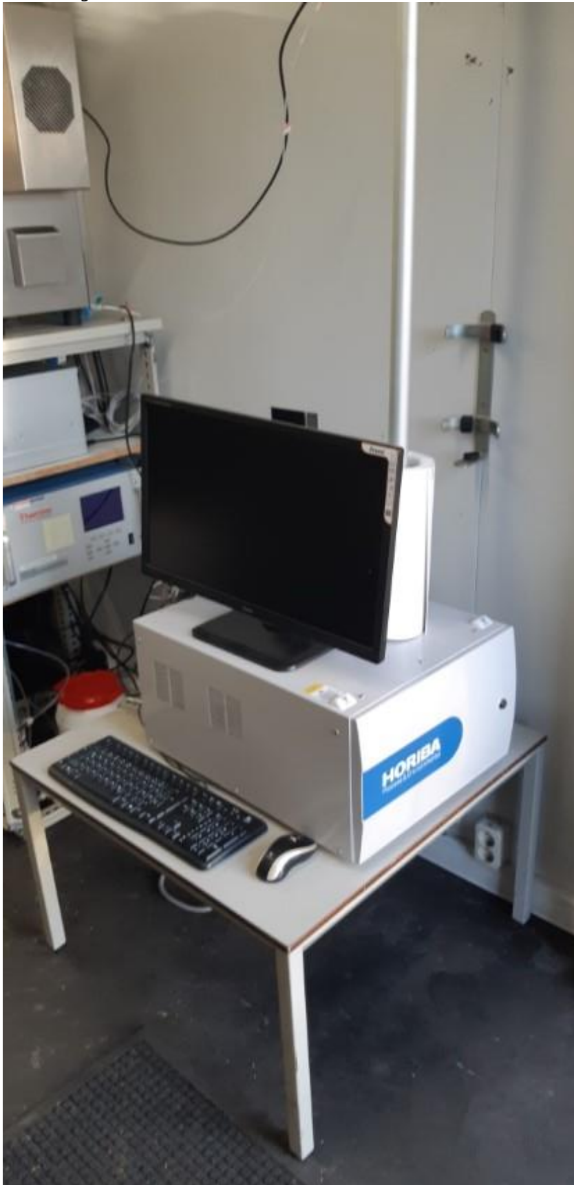
Afbeelding 2: foto van de buitenkant van de automatische metalen monitor Horiba PX-375
