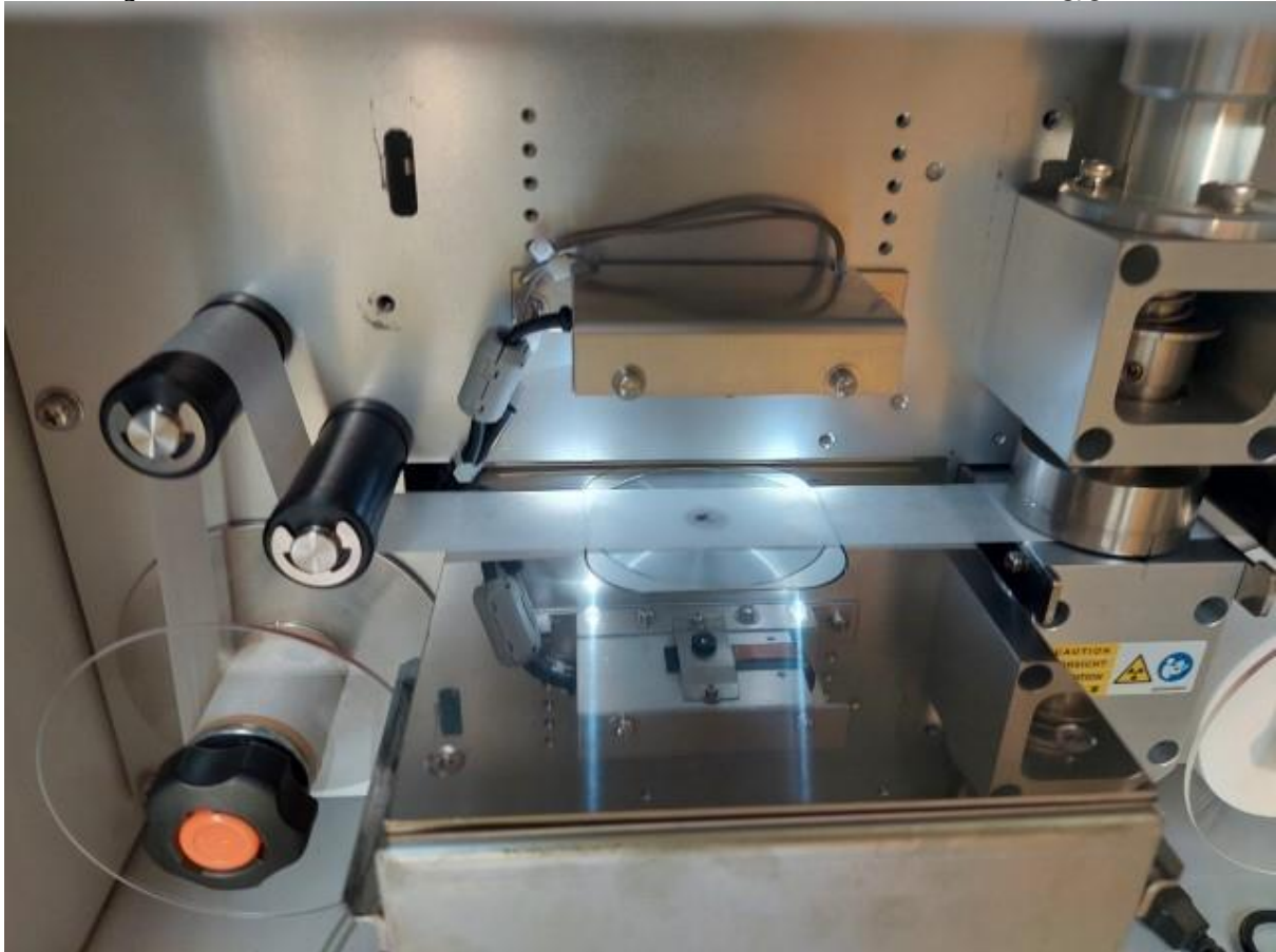
Afbeelding 1: foto van de binnenkant van de automatische metalen monitor Horiba PX-375
