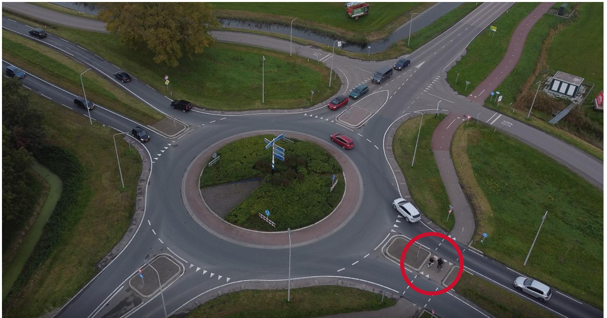
Figuur 2-9 Verkeersaanbod op de hoofdrijbaan leidt tot beperkte wachttijden (<20 seconden) voor overstekend fietsverkeer
