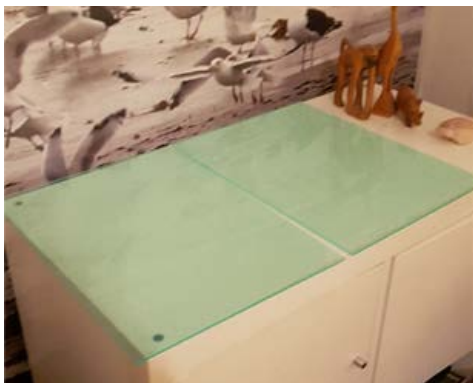
Figuur B1.1 Voorbeeld van een PDT-plaat monsternameplaat in een woning. Een plaat wordt gebruikt voor analyse van PAK en de andere plaat voor analyse van metalen
