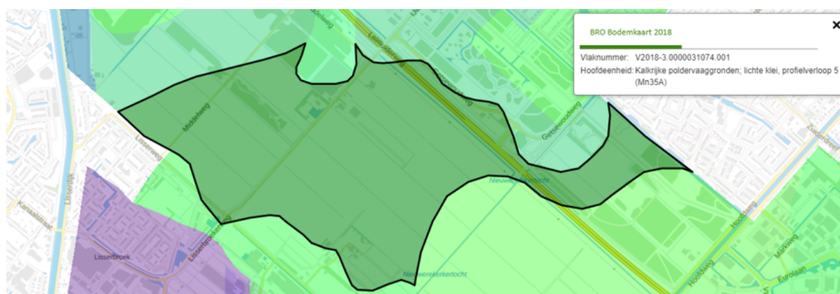
Figuur 5-11: De BRO Bodemkaart 2018 geeft aan dat de ondergrond hoofdzakelijk bestaat uit kalkrijke poldervaaggronden met lichte klei. Bron: DINO-loket
