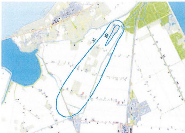
Fig. 1. Contouren van LAeq, 24h = 35 dB(A) en 50 dB(A) met 30 starts met Dimona motorzwever.
