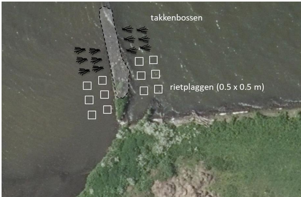
Afbeelding 3.16 Opzet van de proef met de luwtestructuur. Het deel binnen de gestippelde lijn dient extra te worden opgehoogd. Rechts worden rietplaggen en takkenbossen geplaatst aan loefzijde (geëxponeerd) en links materiaal aan lijzijde (in luwte)
