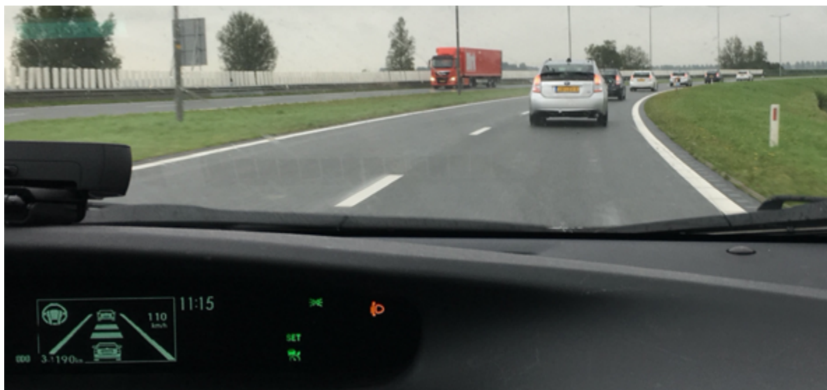
Konvooi van 7 auto's met coöperatieve adaptieve cruise control (CACC) op N205 in september 2018.
