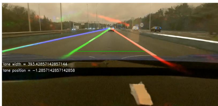
Figuur Links: Hulpmiddel voor berekenen rijstrookpositie en -breedte. Figuur Rechts: geautomatiseerde detectie van de systeemstatus en bedieningsinformatie.
