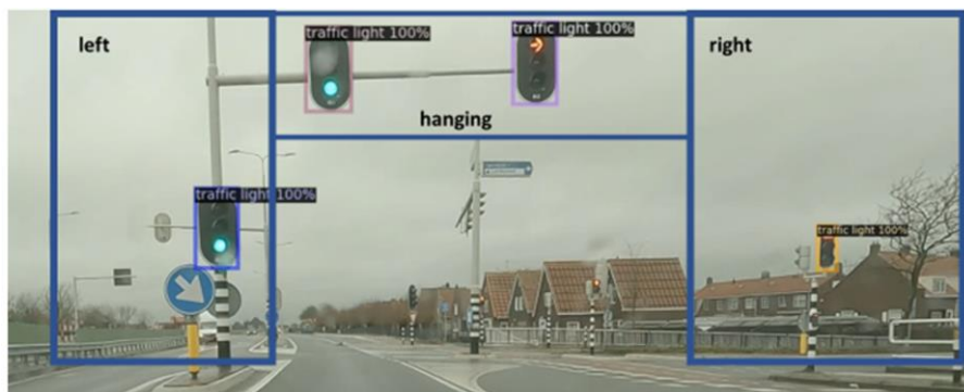
Figuur: voorbeeldresultaten van het model voor de detectie van verkeerstekens
