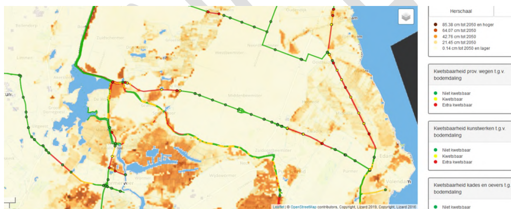
Figuur 4: Bodemdalingskaart met de knelpuntenkaarten voor wegen, kunstwerken en kades en oevers (vaarwegen).
